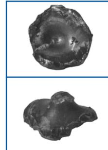
**Symptome:** Rauer Motor, plötzliches mechanisches Geräusch.
