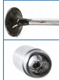
**Symptome:** Schlechte Leistung durch niedrige Kompression, Mechanischer Bruch aufgrund festhängender Ventile.
